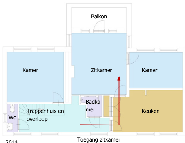
Afb. 2.4 Plattegronden van de eerste etage met indeling en gebruik in 1913 en 2014. Tekening nr KMR00301BB01 (2008), bijgewerkt naar beide situaties door auteur.
