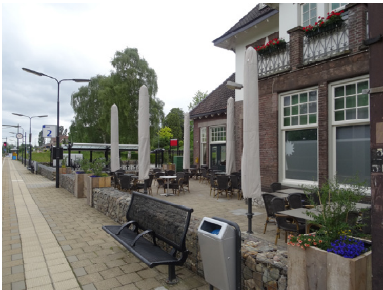
Afb. 4.18 Het terras bij de brasserie, tussen gebouw en perron 1. De rand van schanskorven scheidt het stationsgebouw met terras van het perron. Hier passen de zwerfkeien fraai bij de gebouwplint met rusticamotief van natuursteen.
