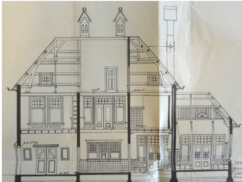
Afb. 5.36 Uitsneden uit de bestekstekening. Boven; doorsnede van oost (links) naar west.
